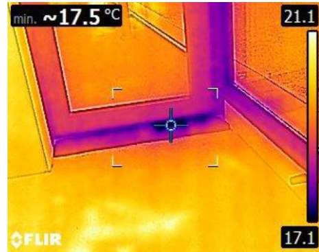
Op thermo grafische beelden zijn de luchtstromen t.p.v. (sluit)naden en glaslatontmoetingen te zien door de magenta kleuren (koude lucht).
